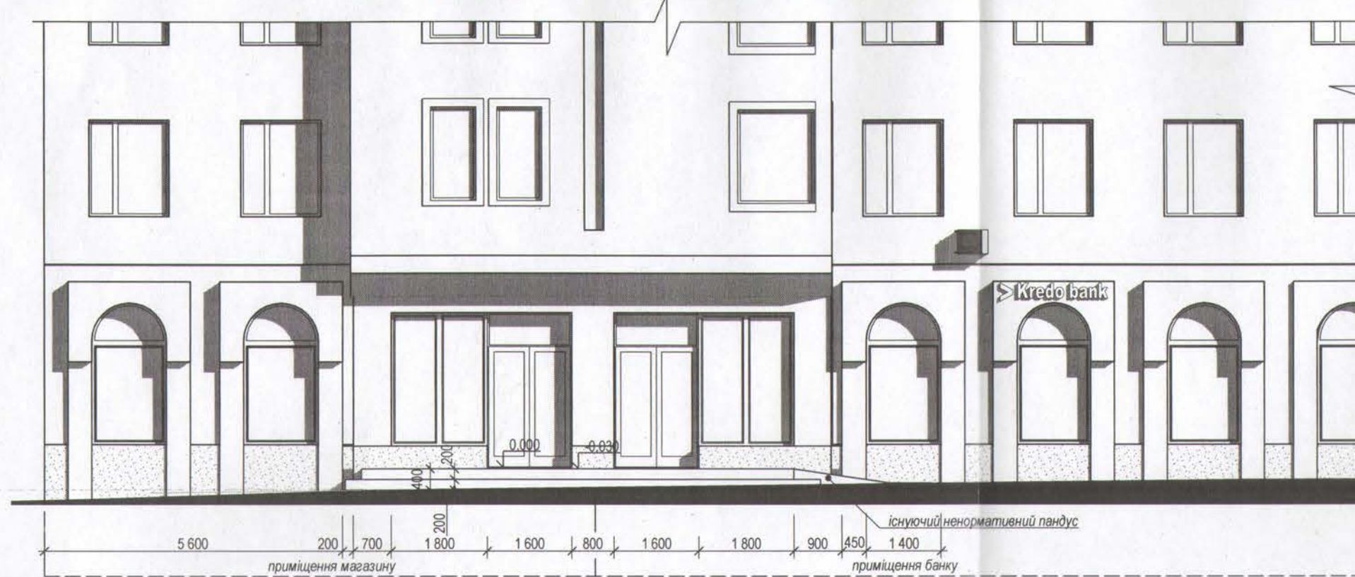
Фрагмент фасаду будинку М 1:100 (обмірні креслення).
