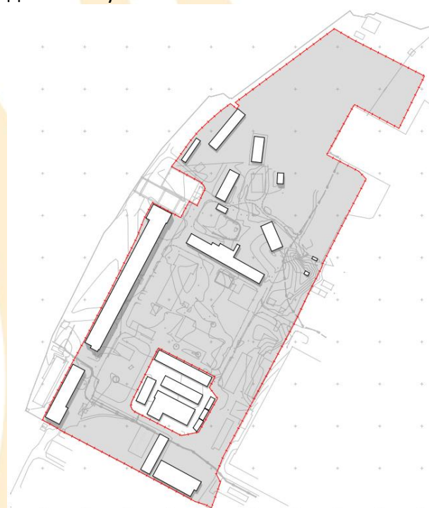
Схема будівель що залишаються після демонтажу
